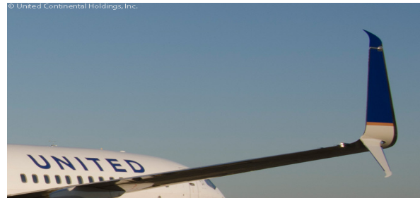
Figura 1: Exemplo de Winglets localizado na ponta da asa da aeronave.
