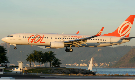
Figura 4 – Blended Winglet na aeronave Boeing 737-800 da GOL Linhas Aéreas
