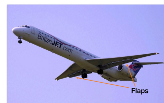
Figura 10 - Localização dos flapes, mais ao centro da asa (avião em procedimento de decolagem ou aproximação para pouso).
