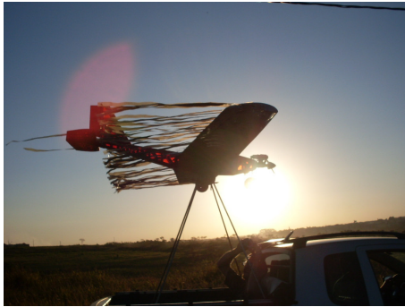
Figura 6 – Ensaio visual da esteira de vórtices
