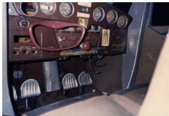
Figura 6 – Painel do Cessna “Brasil” avião utilizado no reide das três américas.
