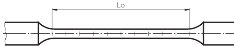
corpo de prova antes do ensaio de tração
