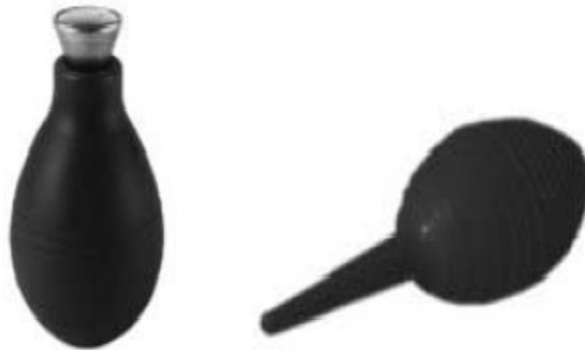
Figura 11 – Aspersores de borracha para aplicação de partículas magnéticas secas,
