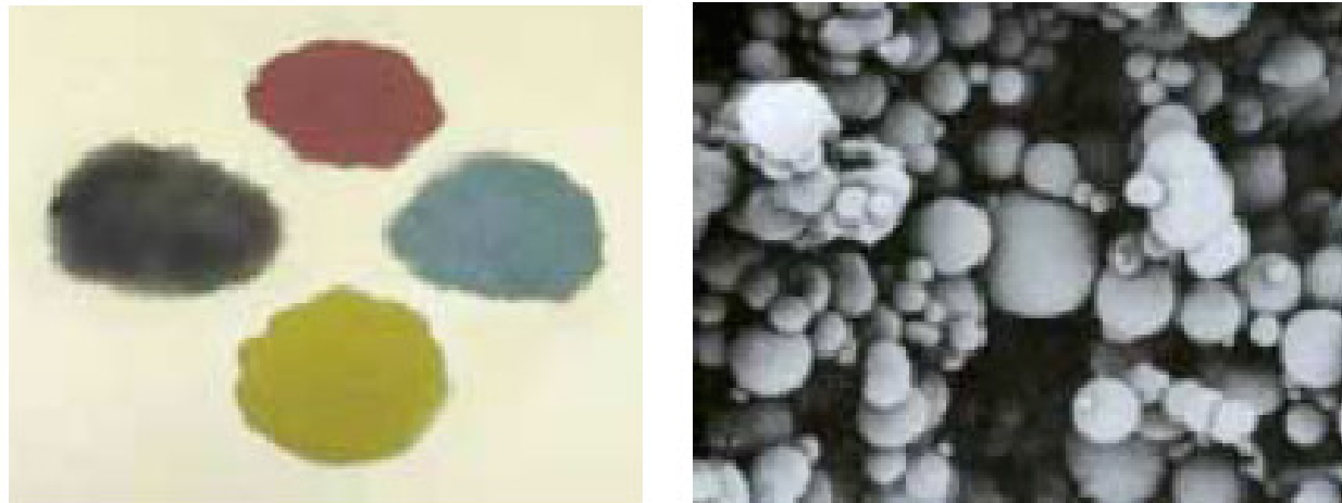
Figura 10 – Partículas magnéticas coloridas vistas a olho nu e ao microscópio eletrônico.
